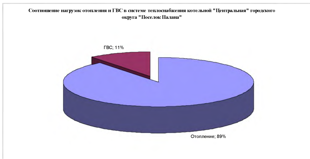
Рисунок 1.4. Соотношение нагрузок отопления и ГВС в системе теплоснабжения от котельной «Центральная» городского округа «Поселок Палана».
