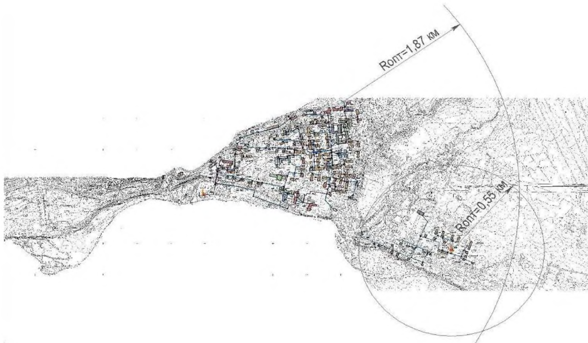
Рисунок 2.4. Схема административного деления городского округа «Поселок Палана» с указанием расчетных элементов территориального деления (кадастровых кварталов) и радиусов эффективного теплоснабжения для каждого источника теплоты.
